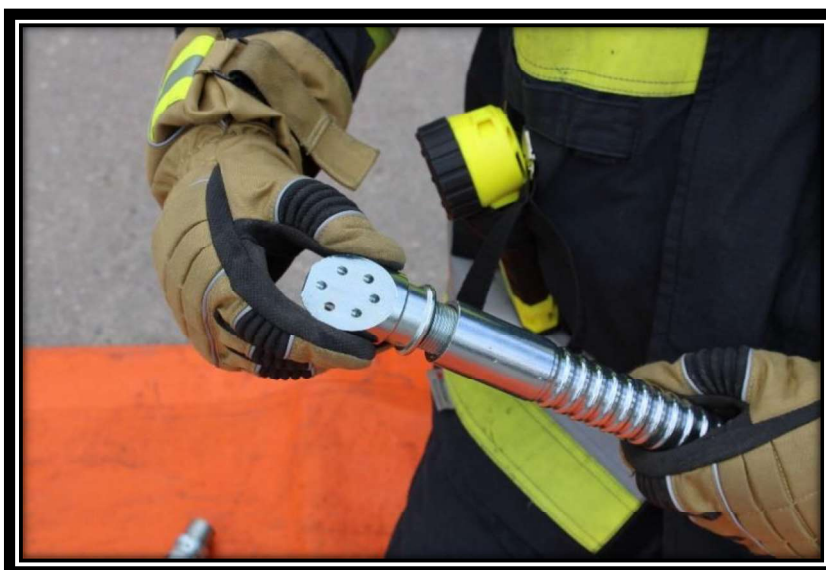
■ Installazione della testa di difesa
