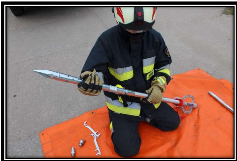
■ Installazione della testa per torba e legni
