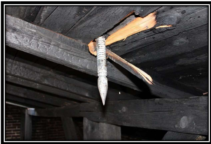
■ Penetrazione con una lancia standard
